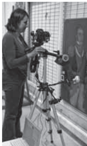
Carolina Correa implementando el sistema de Fotografía Digital Infrarroja con iluminadores LED infrarrojo (IRED) para el estudio de pinturas de caballete.
