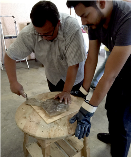
Figura 3. Desmontaje de molde de fibra de vidrio (Fotografía: Hernández, A. 2017).
